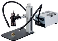
Los sistemas de fibra óptica constan de una fuente lumínica y una guía de luz de fibra óptica. Al utilizar fibra óptica, la muestra no se ve afectada en absoluto por el calor.
