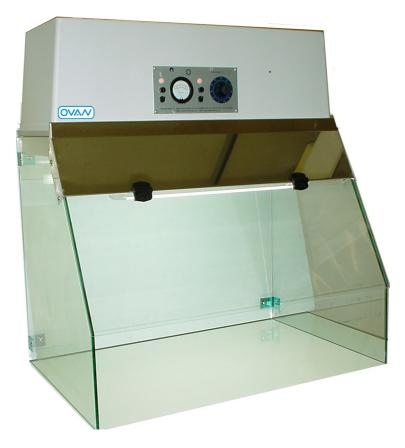
El aire fluye desde la parte superior a través de un prefiltro plegado G4.Luego es succionado por una turbina silenciosa y enviada, a través, del filtro absoluto Hepa al área de trabajo
