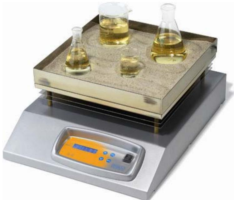
**Baño de arena digital**, controlado por microprocesador.
