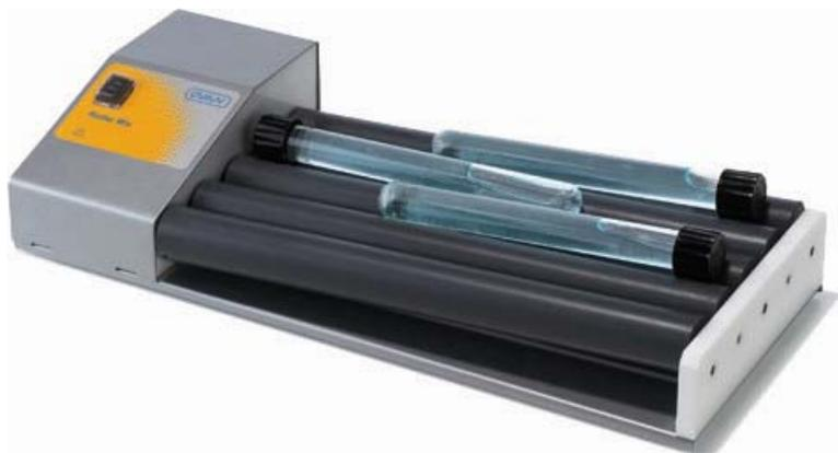
Agitador rotatorio y oscilante de rodillos
