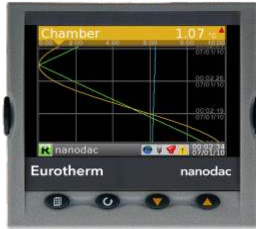
Control para ensayo ICH, opcional según 21 CFR Parte 11 de FDA
